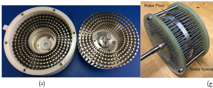
شکل ۱: ساختارهای مطرح در موتورهای الکترواستاتیکی الف و ب) موتورهای محوری (دیسکی) و اجزای آن، ج) و د) موتورهای میله‌ای و اجزای آن
